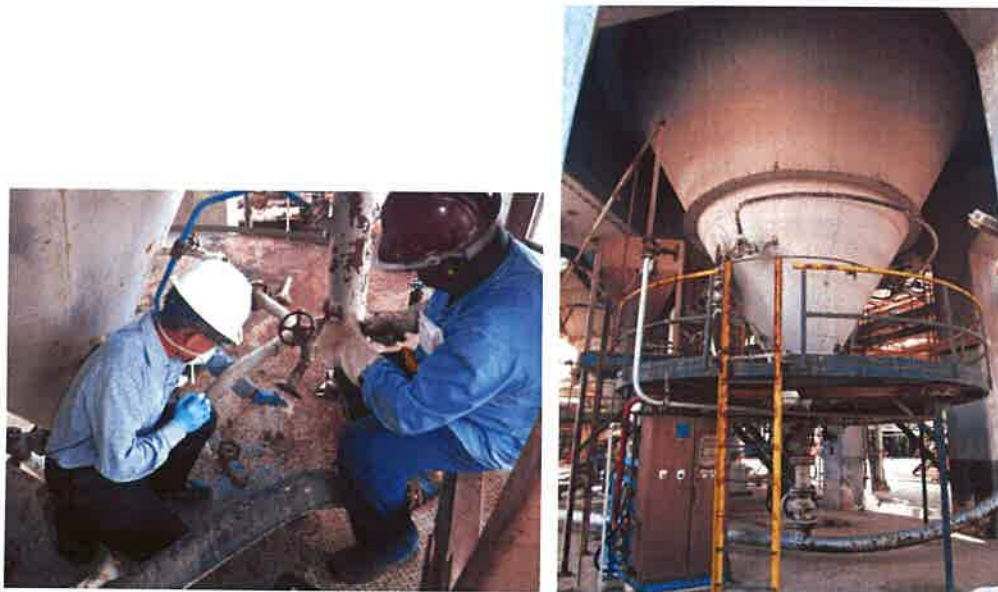
Figuur 2.1 Bemonstering ongebruikte katalysatorstof (links) en de desbetreffende installatie (rechts).
